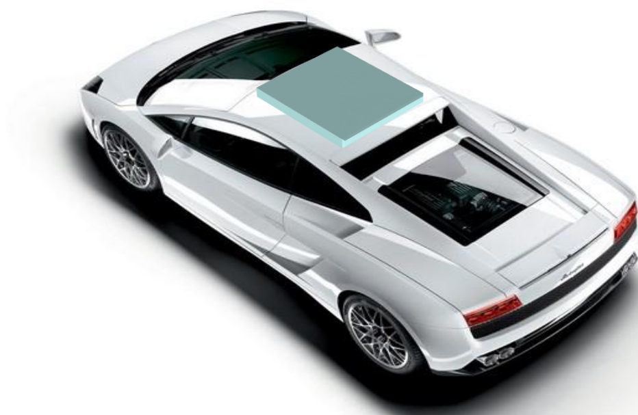
Рисунок 2 - Использование преобразователя солнечной радиации в электроэнергию для питания автомобильного кондиционера на основе полупроводниковых термоэлектрических устройств с применением эффекта Пельтье
