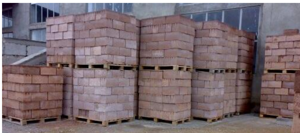
Рисунок 3 – Опытная партия стеновых керамобетонных блоков
