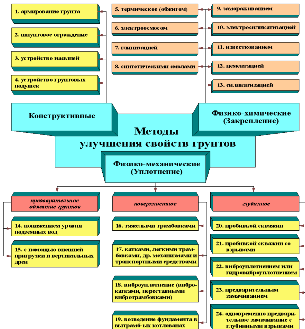
Рисунок 1 - Классификация методов улучшения свойств грунтов: 1-24 – номера способов улучшения свойств грунтов
