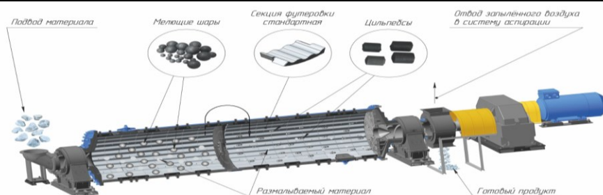
Рис. 1 - Схема шаровой мельницы [23]
