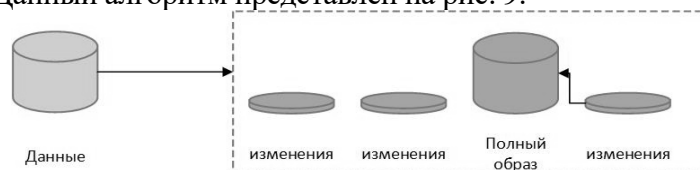
Рис. 9 – Алгоритм реверсивного инкрементального резервного копирования Fig. 9 – Algorithm of reverse incremental backup
