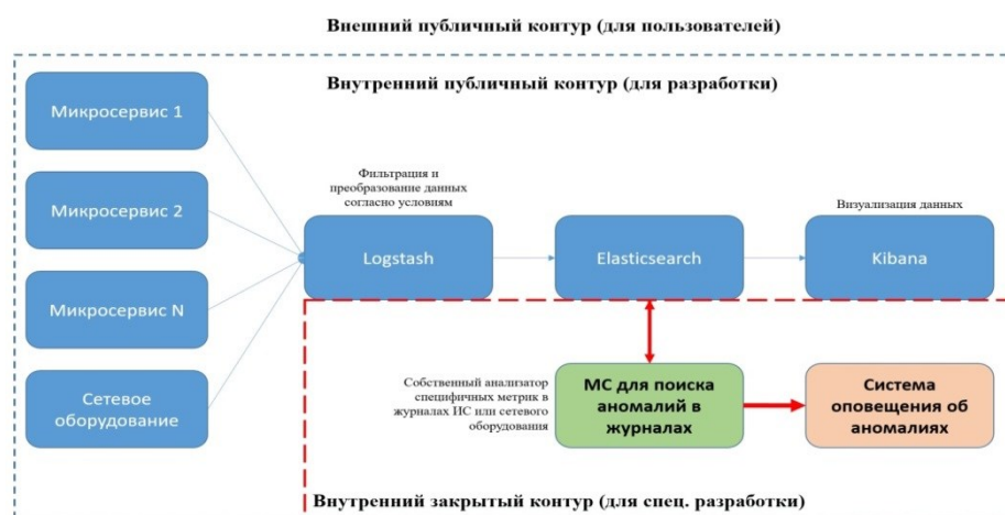
Рис. 3 - Пример архитектуры ИС с использованием интеграции с специализированным java-приложением по анализу журналов на предмет наличия аномалий Fig. 3 - An example of an IS architecture using integration with a specialized Java application for analyzing logs for anomalies
