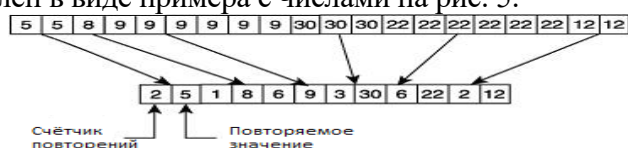
Рис. 5 – Принцип алгоритма RLE на примере последовательности чисел
