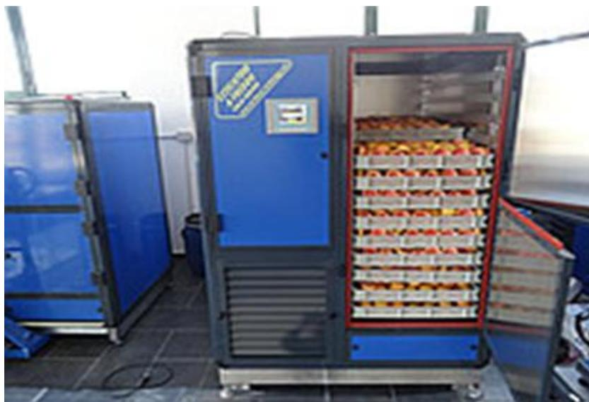
**Рисунок 1** - Термокамера для сушки холодным воздухом овощей, фруктов, зелени, ягод и грибов
