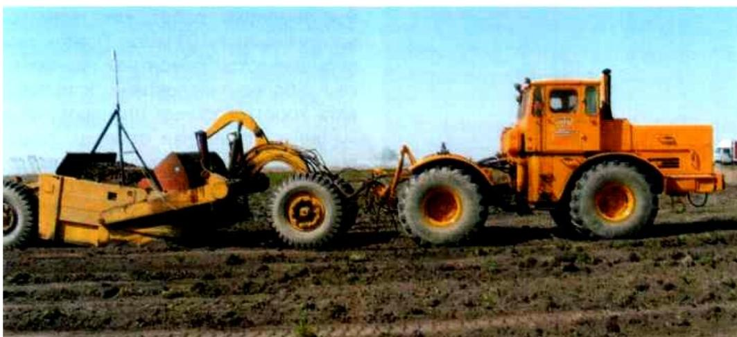
**Рисунок 3 - Скрепер ДЗ-77 с лазерно-приемным устройством ОКО-30**
