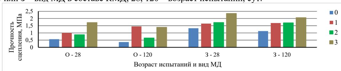
Рис. 4. Зависимость прочности сцепления со стандартным бетонным основанием строительных растворов
