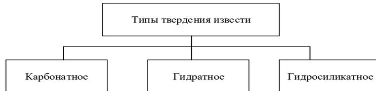
**Рис. 3. Типы твердения известкового вяжущего**
