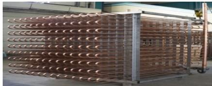
**Рис. 2. Общий вид трубчато-змеевикового испарителя льдоаккумулятора компании AIRCOOL [16]**
