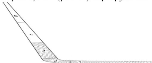
Рис. 14. Схема компоновки полурамы из отправочных марок
