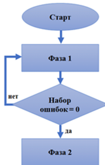
Рис. 3. Блок-схема процесса ATPG, основанного на генетическом алгоритме
