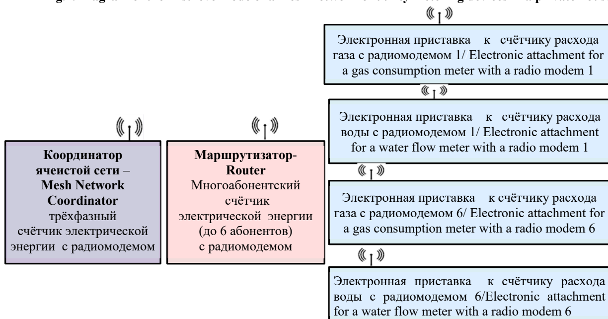
Рис.1. Схема узла первого уровня ячеистой сети приборов учёта коммунальных услуг в частном доме Fig.1. Diagram of the first level node of a mesh network of utility metering devices in a private house
