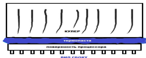
Рис.1. Схема работы термопасты Fig.1. Thermal paste operation diagram
