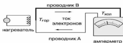
Рис. 3. Схема работы эффекта Зеебека
