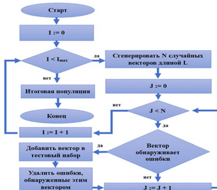
Рис. 4. Блок-схема первой фазы процесса ATPG, основанного на генетическом алгоритме
