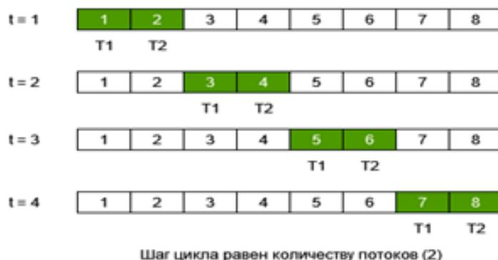
Рис. 5. Доступ к данным при шаге, равному количеству потоков
