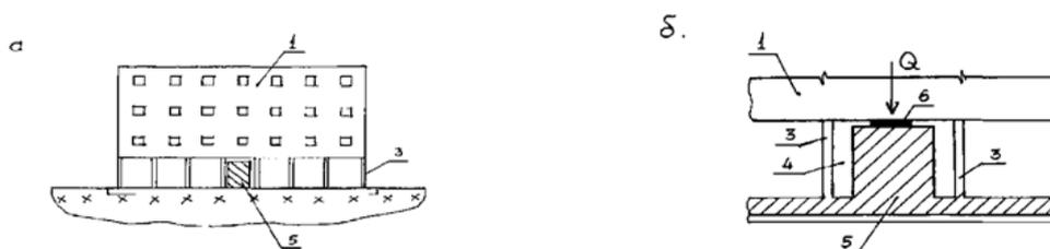
Рис. 4. Здание на гибких колоннах:
