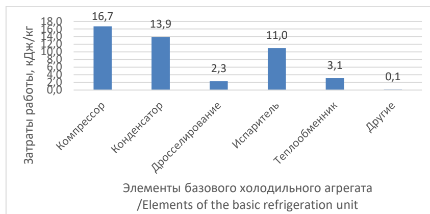
Рис.2. Энергетические потери по элементам базового холодильного агрегата Fig.2. Energy losses by elements of the basic refrigeration unit
