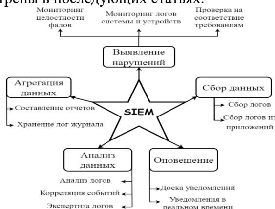
Рис. 1 Функциональные возможности SIEM систем Fig. 1. Functionality of SIEM systems
