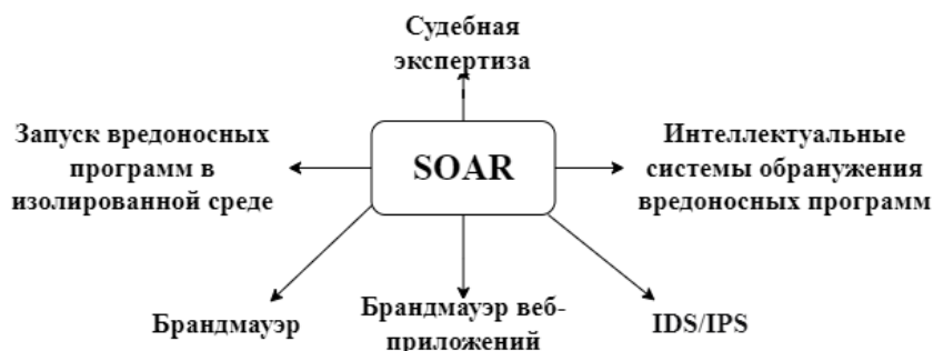
Рис. 2. Функциональные особенности SOAR систем Fig. 2. Functional features of SOAR systems
