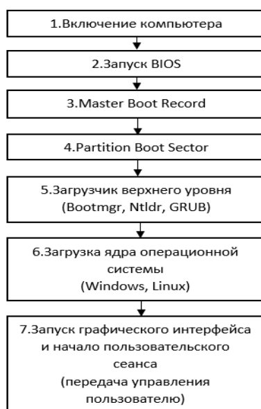
Рис.1. Схема порядка запуска операционной системы Fig.1. Scheme of the order of starting the operating system
