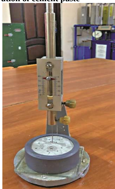
Определение нормальной густоты цементного теста и сроков схватывания
