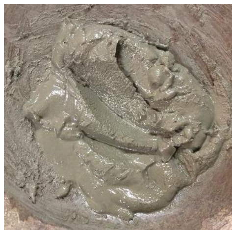
Просеивание ПТЦ и приготовление цементного теста Screening of PTC and preparation of cement paste
