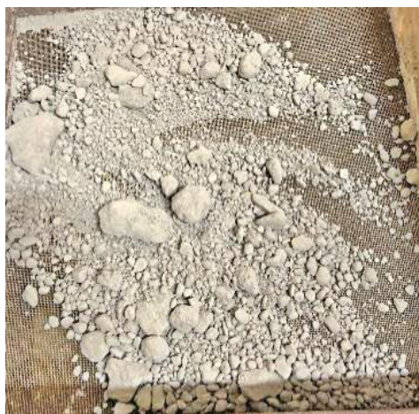
Просеивание ПТЦ и приготовление цементного теста Screening of PTC and preparation of cement paste
