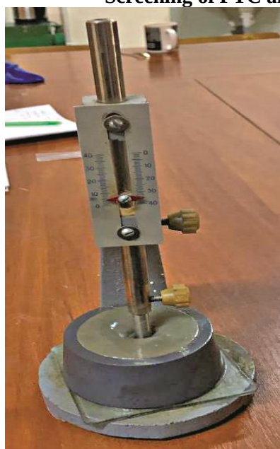
Определение нормальной густоты цементного теста и сроков схватывания
