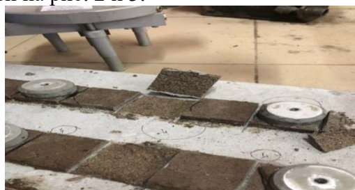
Рис. 2. Проведение испытаний на отрыв раствора от бетонного основания Fig. 2. Conducting tests for the separation of the solution from the concrete base
