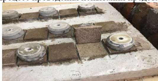
Рис. 2. Проведение испытаний на отрыв раствора от бетонного основания Fig. 2. Conducting tests for the separation of the solution from the concrete base
