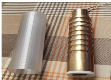
Рис.2. Внешний вид термоэлектрического устройства для извлечения инородного объекта из тела человека с естественным воздушным отводом теплоты от горячих спаев термоэлектрического модуля
