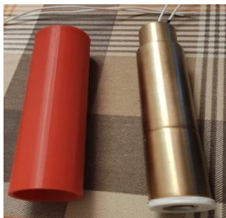
Рис. 6. Внешний вид ТЭУ для извлечения инородного объекта из тела человека с использованием для отвода теплоты от горячих спаев ТЭМ предварительно захлаживаемого радиатора
