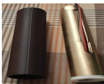
Рис.4. Внешний вид термоэлектрического устройства для извлечения инородного объекта из тела человека с использованием для отвода теплоты от горячих спаев термоэлектрического модуля плавящегося рабочего вещества
