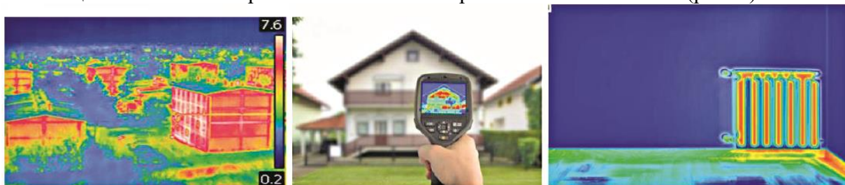
Рис. 1. Примеры использования тепловизионной техники в оценке теплозащитных свойств строительных объектов и тепловом контроле инженерно-технических систем
