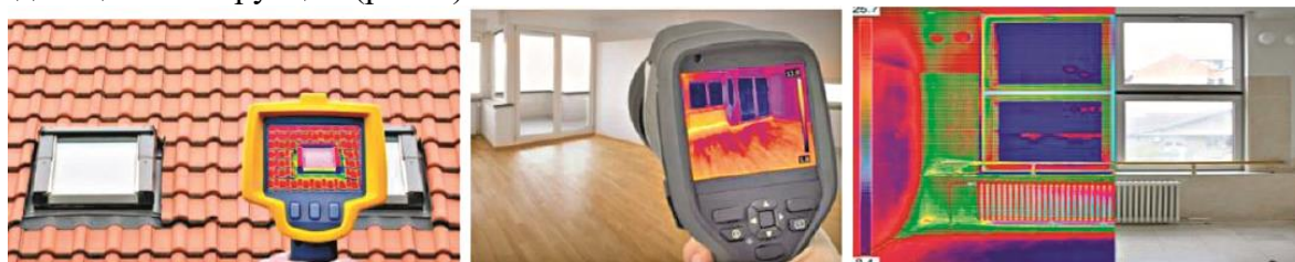
Рис. 2. Примеры термографирования наружных и внутренних поверхностей ограждающих конструкций жилых строительных объектов, систем кондиционирования микроклимата Fig. 2. Examples of thermography of external and internal surfaces of enclosing structures of residential building objects, microclimate conditioning systems
