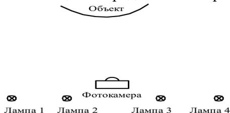
Рис. 2. Взаимное расположение фотокамеры и лампы для определения карты высот
