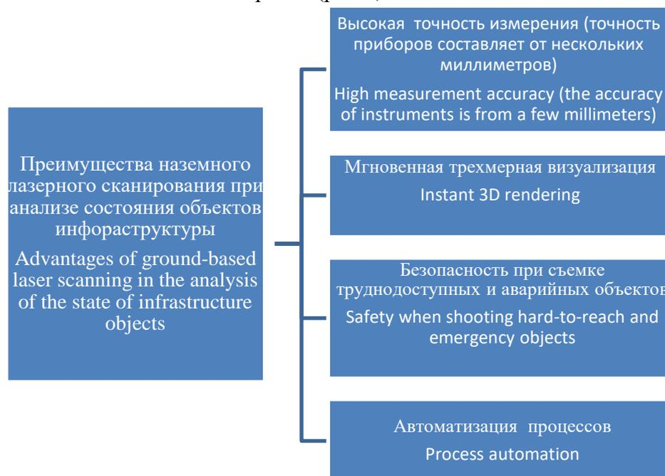
**Рис.2. Преимущества наземного лазерного сканирования**
