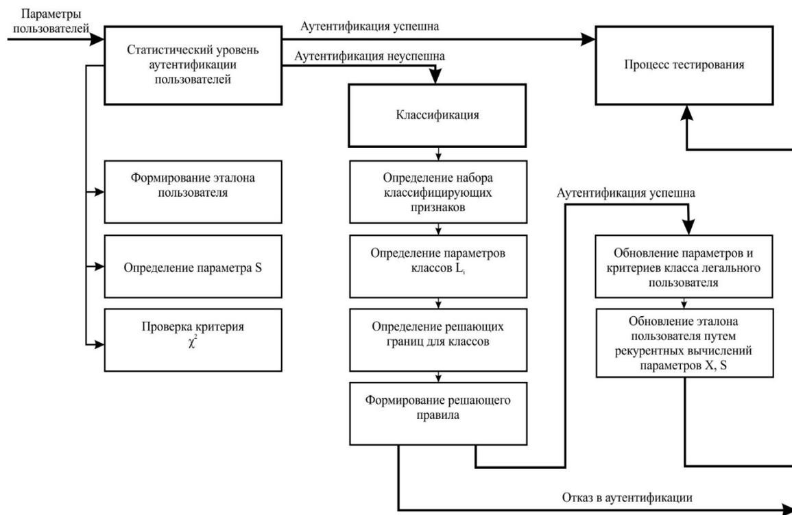
**Рис. 2. Детализация трехступенчатой модели аутентификации пользователей**
