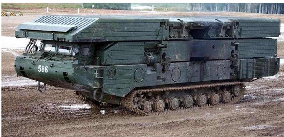
**Рис. 1. Паромно-мостовая машина ПММ-2М в походном положении**
