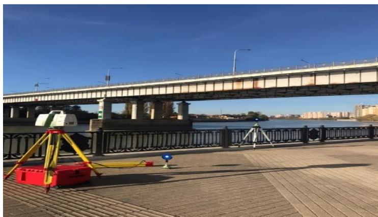
**Рис.3. Выполнение измерений сканером Leica ScanStation C10**
