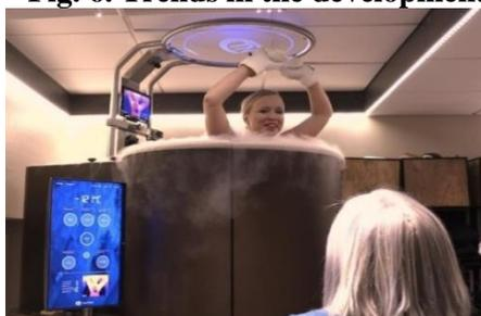
а) Установка CryoCabin (Финляндия) с установленной тепловизионной камерой и большим человеко-машинным интерфейсом
