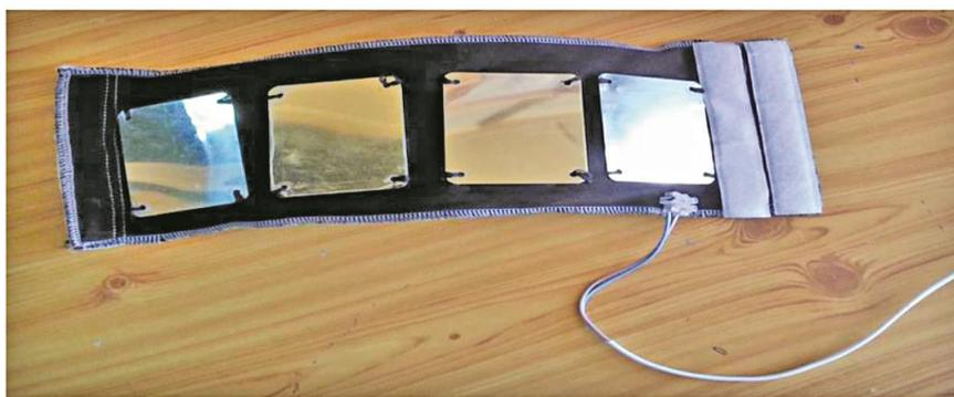
**Рис.6. Внешний вид термоэлектрического полупроводникового устройства для теплового воздействия на отдельные зоны руки человека**
