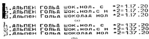
Рис. 8. (а) Применение пороговой бинаризации глобальной, (б) адаптивной бинаризации
