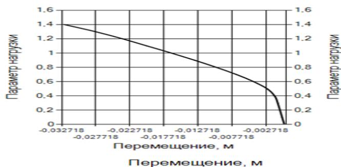
**Рис.17. Кривая нагрузка-прогиб при инициализации трещин, показанных на рис.16.**
