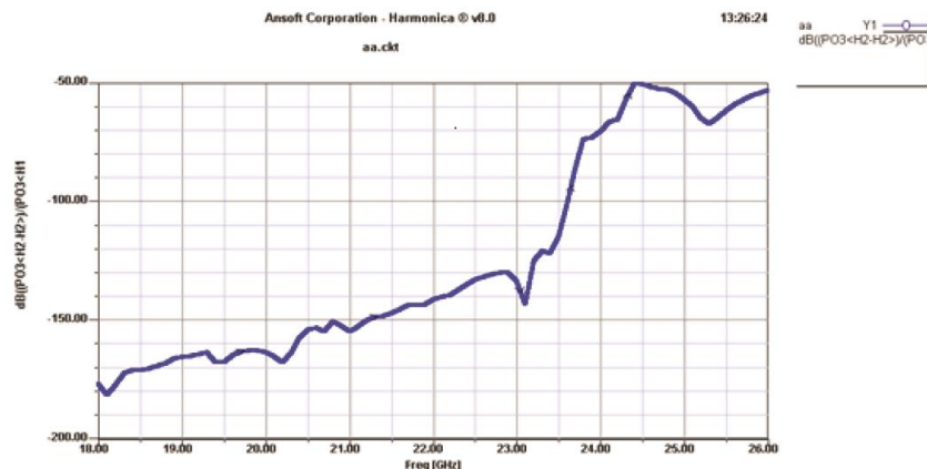
Рис. 13. Уровень гармонических искажений f_{\text{пч(параз)}} = 2(f_g - f_c) (при неидентичности параметров диодов 5 %). Fig. 13. The level of harmonic distortion f_{\text{pch (paras.)}} = 2(f_g - f_c) (with non-identical parameters of the diodes 5%).
