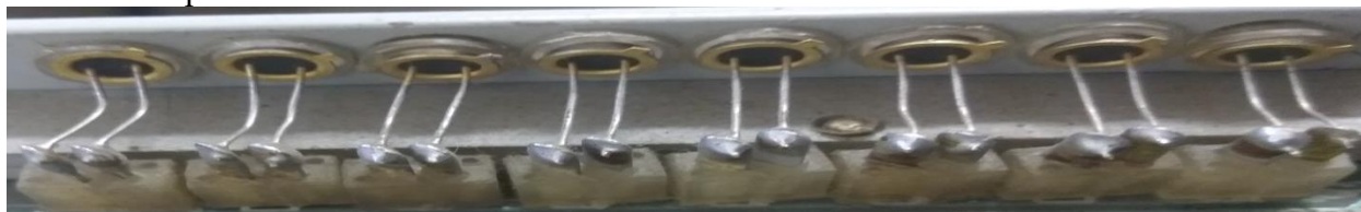
Рис.4. Соединение лицевой панели и печатной платы
