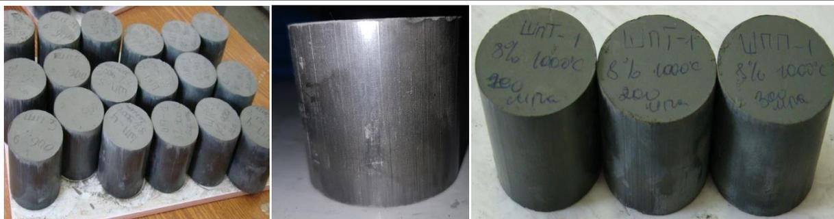
**Рис.6 Отпрессованные образцы на основе отсевов отходов угледобычи**
