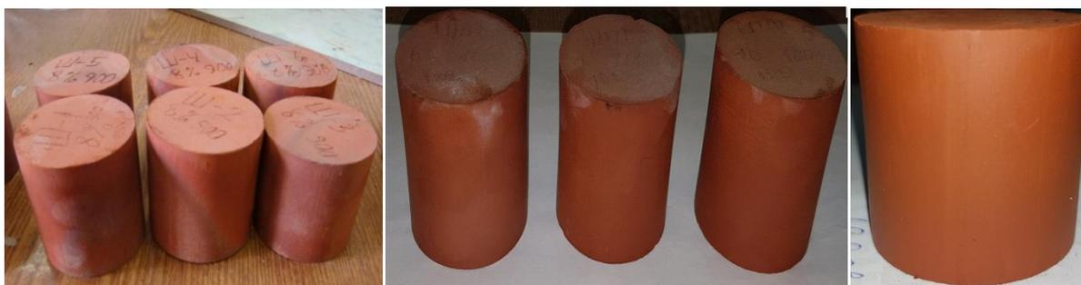
**Рис. 7 Обожженные образцы на основе отсевов отходов угледобычи**
