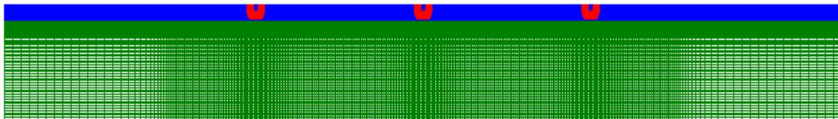
**Рис. 1. Сетка плоского канала, состоящая из нескольких секций с расположенным посередине турбулизатором, входного и выходного гладкого участков (в периодической постановке рассматривается только одна секция)**
