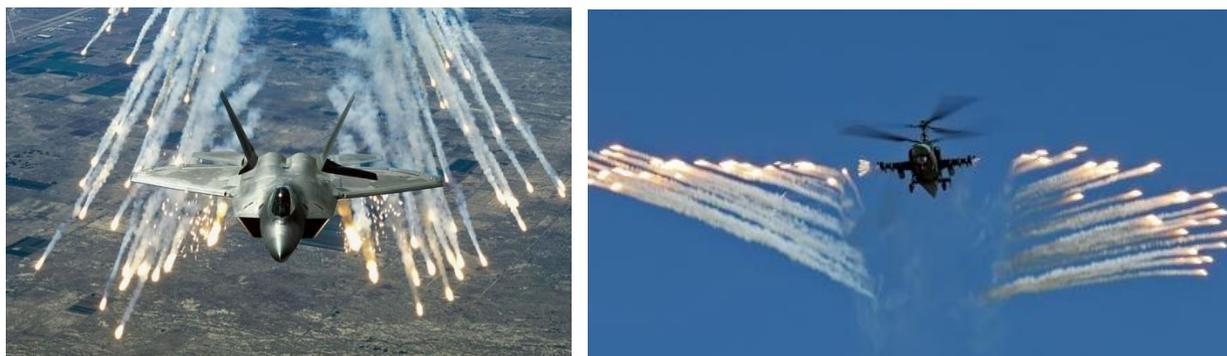
**Рис. 2. Истребитель пятого поколения F-22 Raptor и вертолет КА-52 выпускают тепловые ложные цели для защиты от ракет с инфракрасным датчиком наведения**
