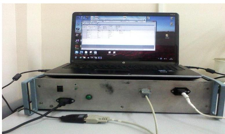
**Рис. 4 Экспериментальный образец генератора, подключенного к ноутбуку для программирования опорной частоты**
