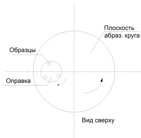
Рис. 2. Принципиальная схема трения стэнда
