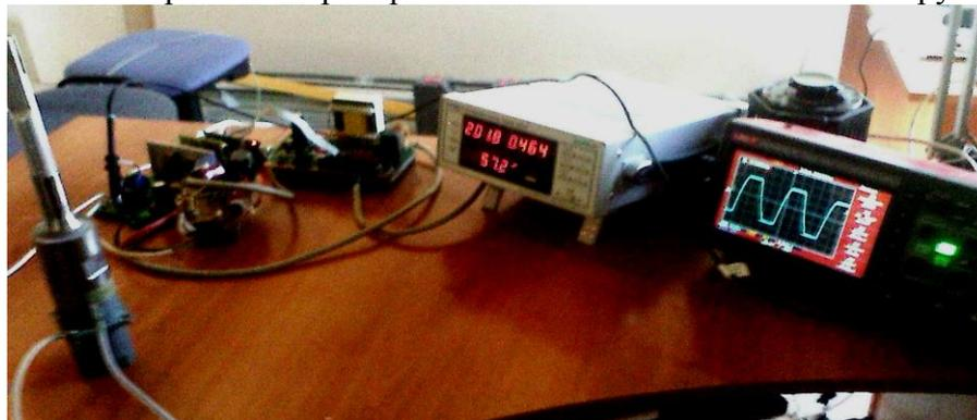
**Рис. 3 Макет схемы многочастотного генератора**
