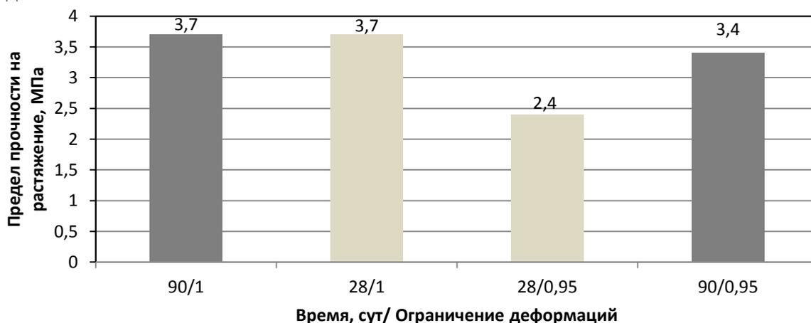
**Рис.4. Предел прочности на растяжение бетона с двухстадийным расширением: 28, 90 – продолжительность твердения в водной среде, сут.;**
