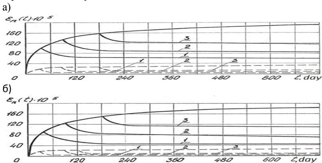
**Рисунок 7** - Обратимость деформаций ползучести газобетона при различной длительности действия нагрузки
