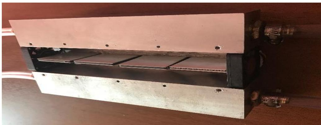
**Рис.2. Внешний вид термоэлектрического интенсификатора теплопередачи**
