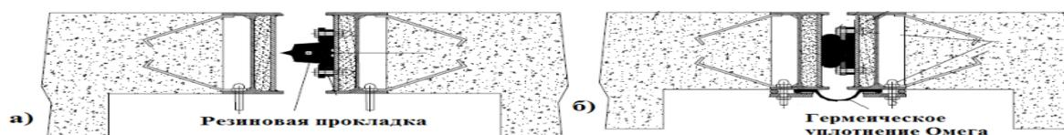
**Рис. 10. Сема соединений между секциями с помощью прокладок: а) до стыковки; б) после стыковки**
