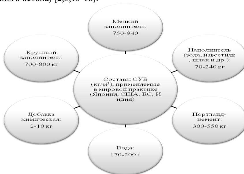
**Рис.1. Состав самоуплотняющегося бетона, применяемого в мировой практике**
