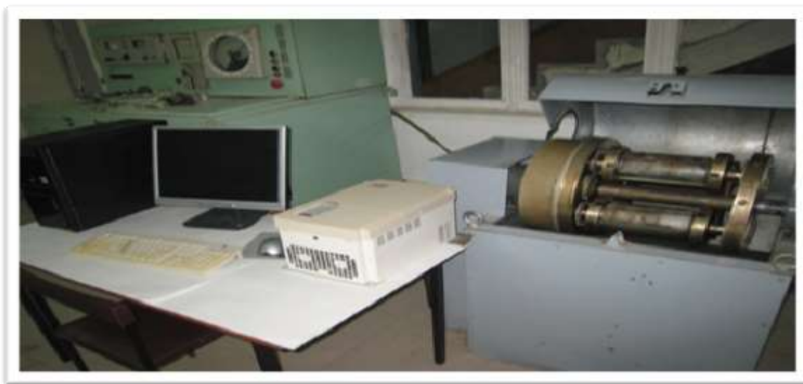
Рисунок 1 - Планетарная мельница «Активатор-4М» с инвертором Toshiba VF11-415OPL.400В,3Ф
