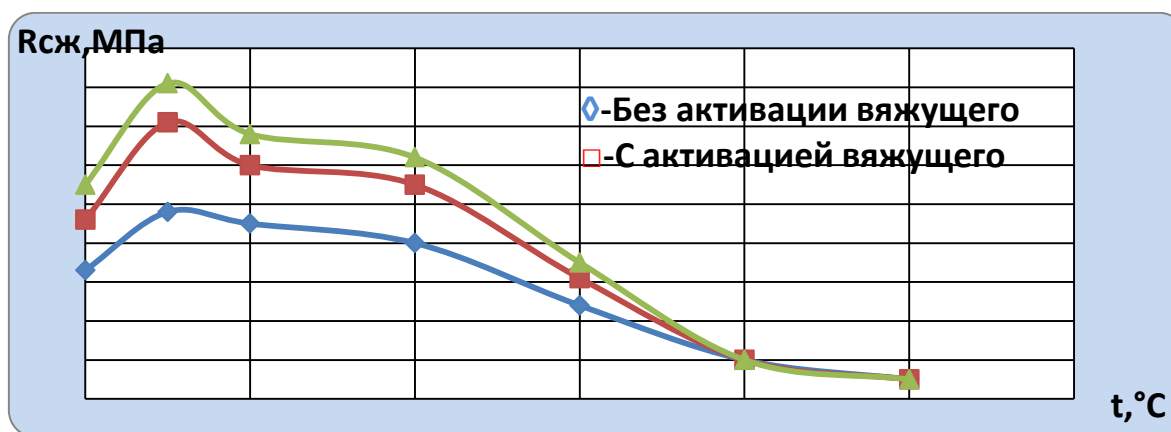
Рисунок 3. Зависимость прочности образцов жаростойкого бетона от температуры нагрева
