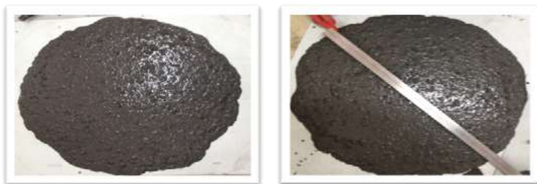
Рисунок 3 – Определение диаметра растекания конуса SCC смесей
