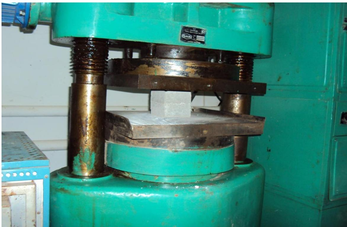
Рисунок 3 - Общий вид машины для испытаний на сжатие
