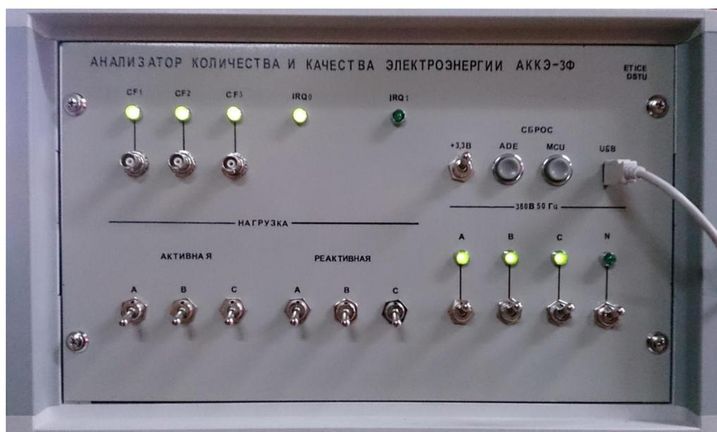
Рисунок 2 - Анализатор количества и качества электроэнергии
