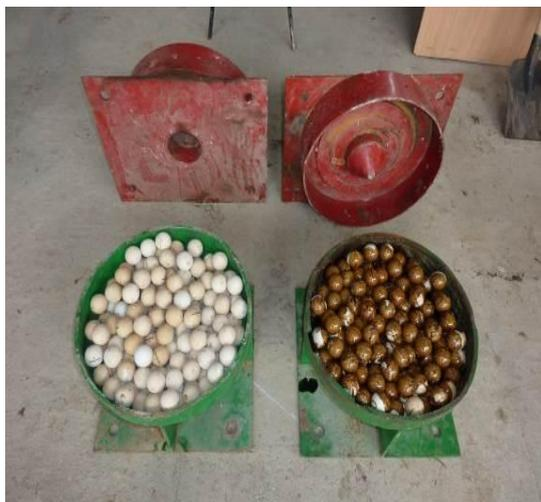
**Рисунок 10** - Варианты заполнения камеры сейсмоизолирующей опоры
