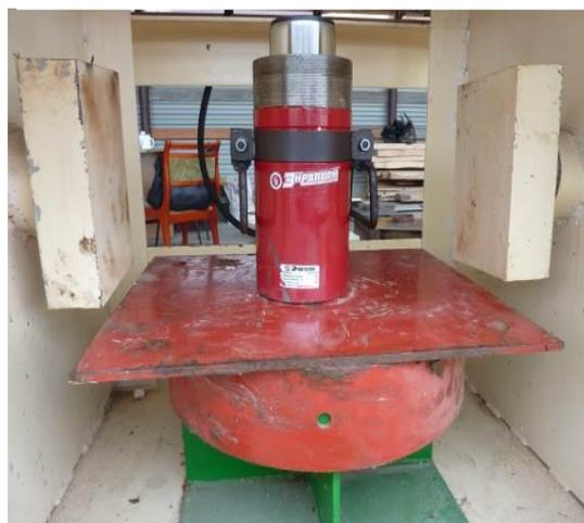
**Рисунок 9** - Испытание металлической конструкции сейсмоизолирующей опоры на перебазируемой установке
