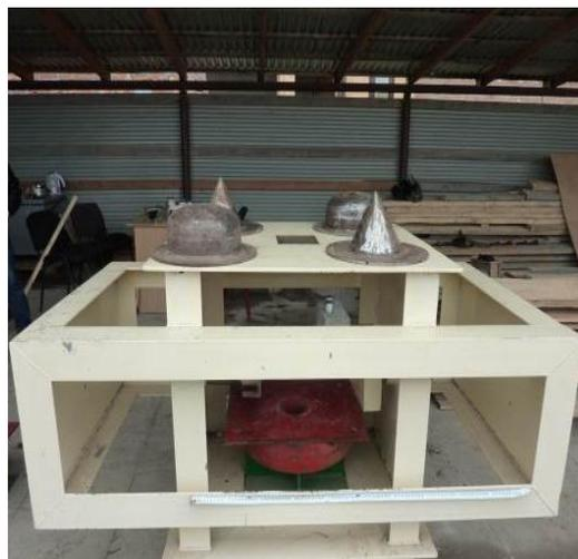
**Рисунок 11** - Полусферические и конусообразные формы верхней поверхности сейсмоизолирующей опоры
