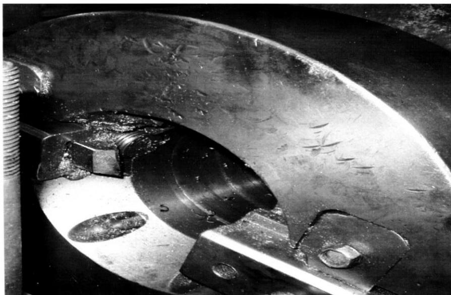
Рисунок 2 - Точение заготовки вихревой головкой с одним резцом
