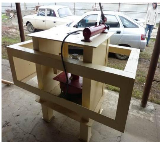
**Рисунок 8** - Перебазируемая установка для испытания сейсмоизолирующего тарельчатого фундамента
