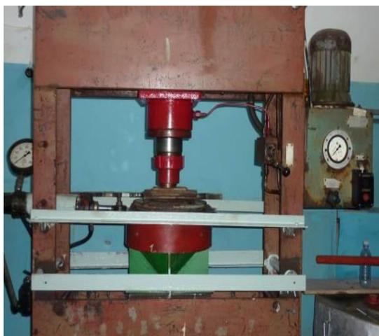
**Рисунок 6** - Стационарная установка для испытания сейсмоизолирующего тарельчатого фундамента
