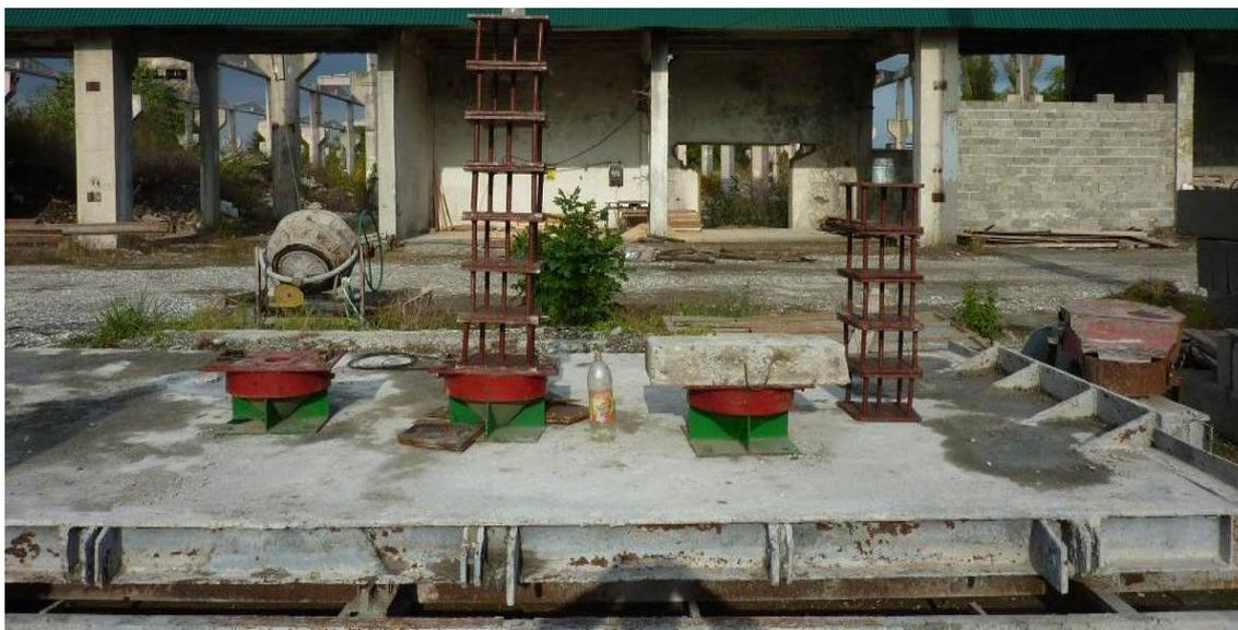
Рисунок 14 - Испытание сейсмоизолирующих тарельчатых опор на вибрационные воздействия
