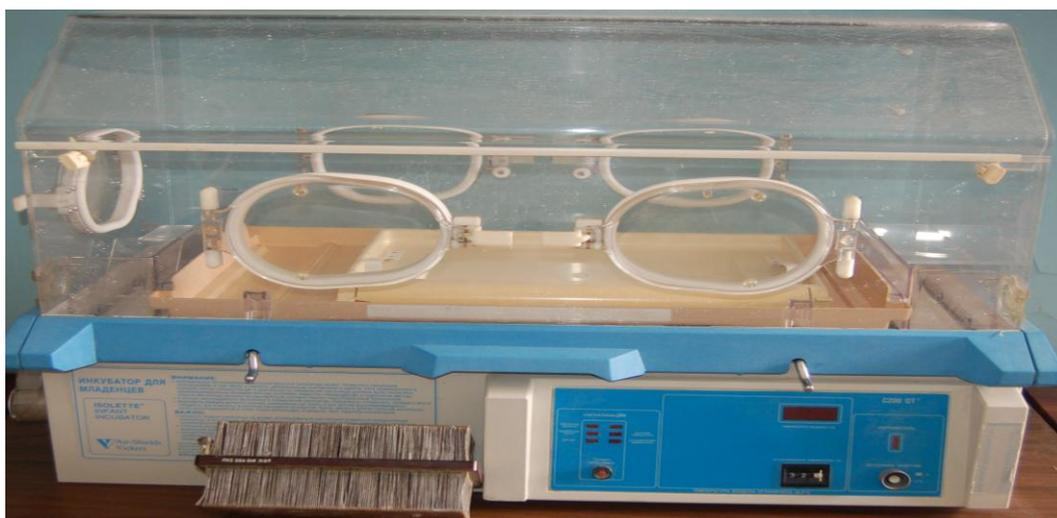
**Рисунок 2** - Внешний вид опытного образца неонатологического реанимационного комплекса
