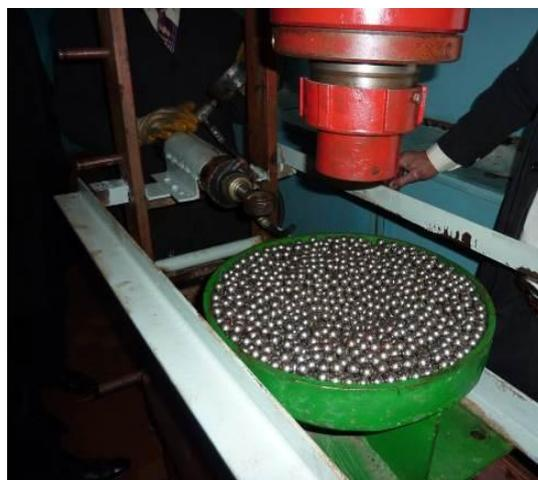
**Рисунок 7** - Опора, наполненная металлическими шариками (перед испытаниями)
