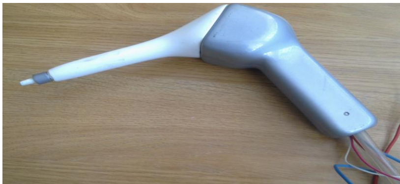
Рис. 2. Внешний вид термоэлектрического прибора для внутрисполостного теплового воздействия с дополнительной термоэлектрической батареей Fig. 2. Appearance of a thermoelectric device for intracavitary thermal exposure with an additional thermoelectric battery
