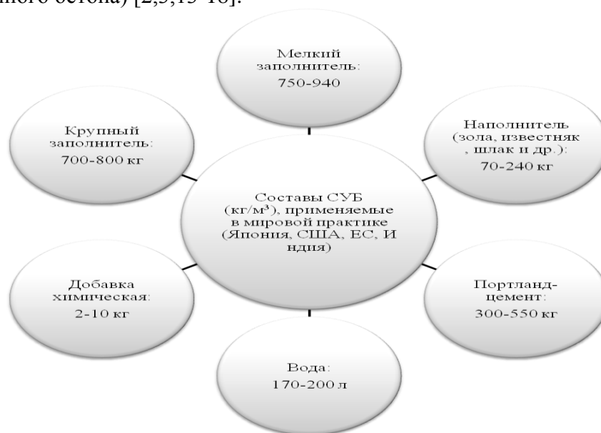
Рис.1. Состав самоуплотняющегося бетона, применяемого в мировой практике
