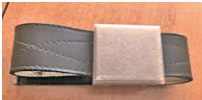
Рис. 2. Внешний вид лабораторного образца термоэлектрического устройства для остановки кровотечения
