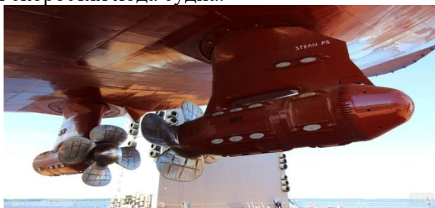
Рис. 8. Полноповоротные винторулевые колонки ледокола «Обь» Fig. 8. Full-revolving Rudderpropeller of the icebreaker "Ob"
