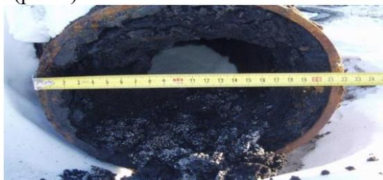
**Рис.1. Пример асфальтосмолопарафиновых отложений (АСПО)**
