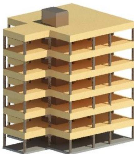
**Рис.7. Итоговый вид конструкции здания с перекрытиями**
