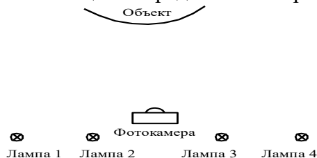
Рис. 2. Взаимное расположение фотокамеры и ламп для определения карты высот
