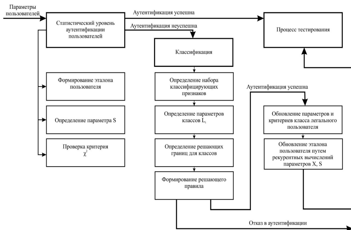
Рис. 2. Детализация трехступенчатой модели аутентификации пользователей Fig.2. Detailing a three-step user authentication model
