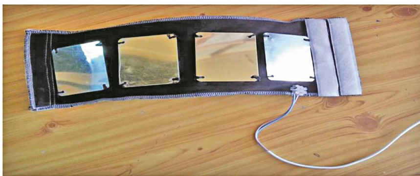
Рис.6. Внешний вид термоэлектрического полупроводникового устройства для теплового воздействия на отдельные зоны руки человека
