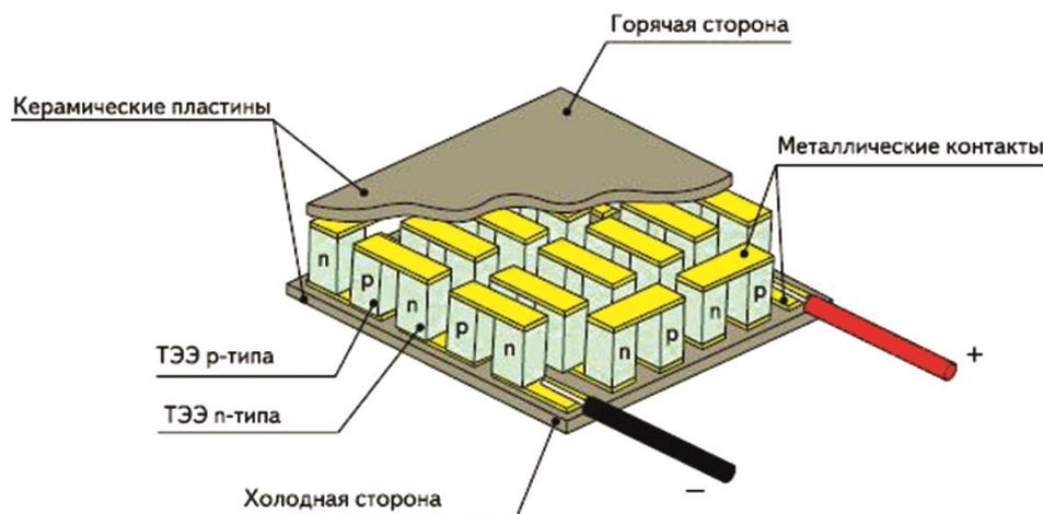
**Рис. 5. Солнечный полупроводниковый термогенератор**
