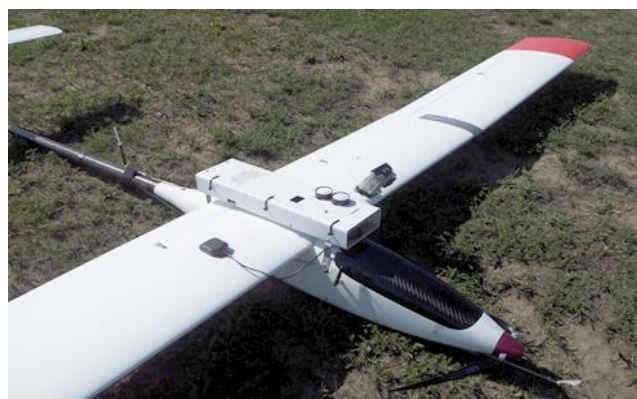
Рис. 2. Измерительный модуль, установленный на БЛА Chelidon собственной конструкции Fig. 2. The measuring module mounted on a self made robotic aircraft called Chelidon
