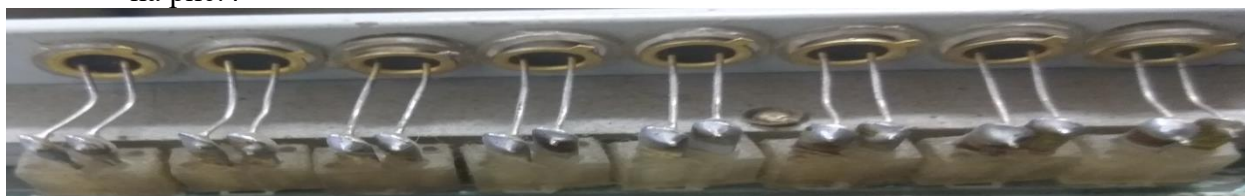
Рис.4. Соединение лицевой панели и печатной платы
