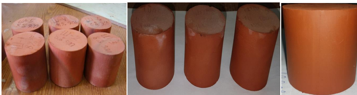
Рис. 7 Обожженные образцы на основе отсеков отходов угледобычи Fig. 7 Burned samples based on coal mining screenings
