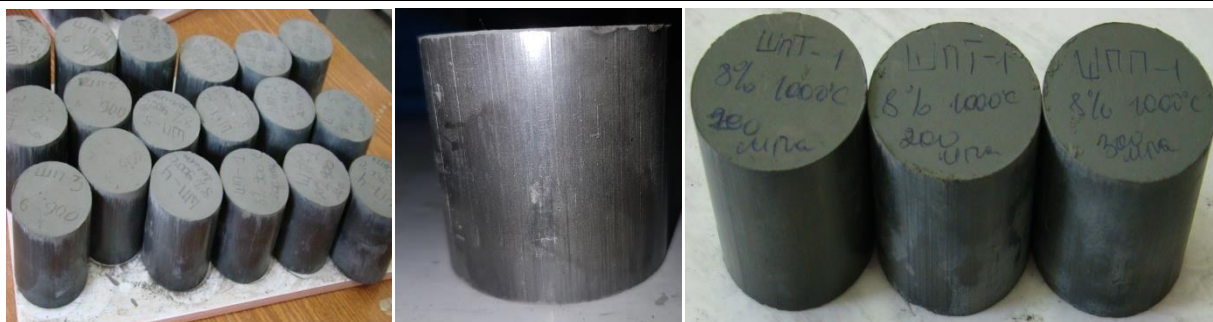
Рис.6 Отпрессованные образцы на основе отсеков отходов угледобычи Fig.6 Pressed samples based on screenings of coal waste
