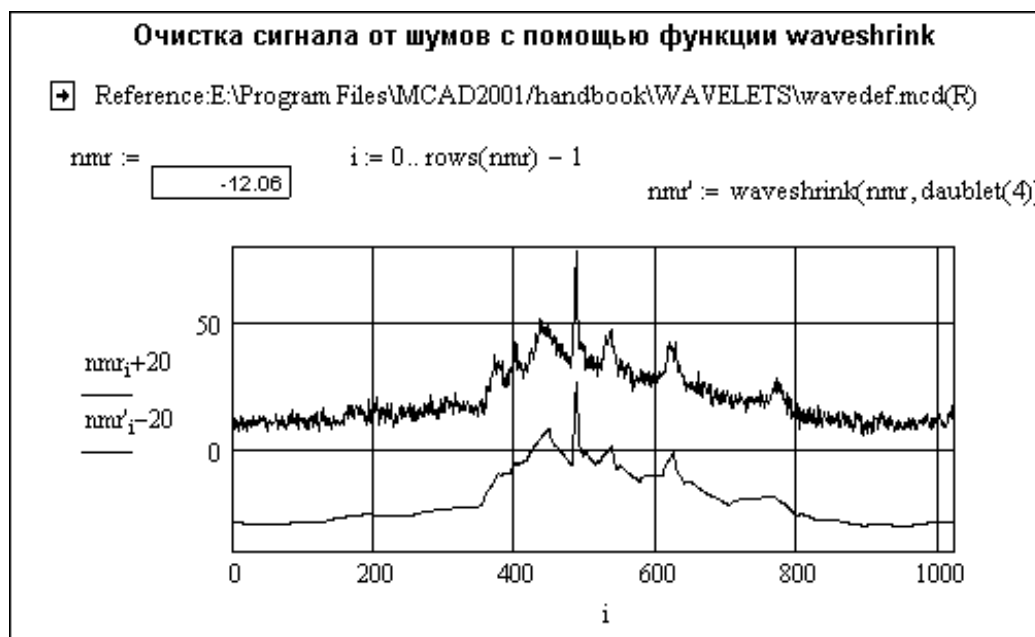
Рис. 3. Пример обработки данных от установки для исследования ядерно-магнитного резонанса Fig. 3. An example of data processing from the installation for the study of nuclear magnetic resonance
