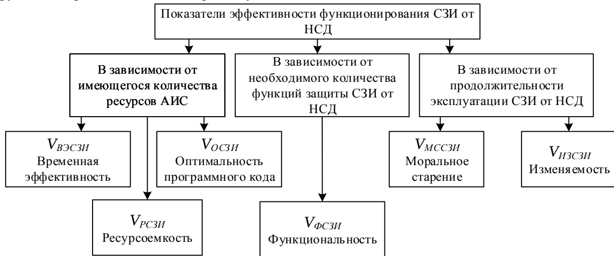
Рис. 1. Структурная схема показателей эффективности функционирования системы защиты информации от несанкционированного доступа в автоматизированной информационной системе Fig. 1. Structural diagram of the performance indicators of the information protection system from unauthorized access in the automated information system
