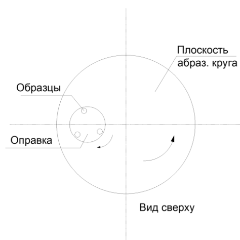
Рис. 2. Принципиальная схема трения стенда Fig. 2. Schematic diagram of the friction stand
