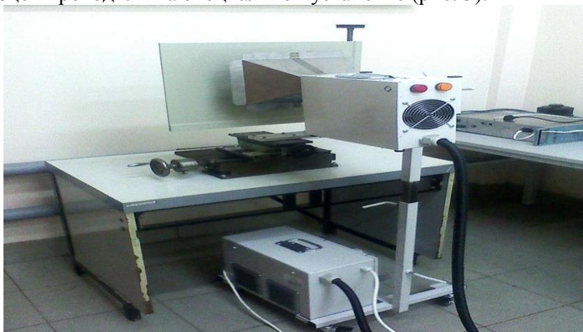
**Рис. 3. Экспериментальная установка для обработки материалов в СВЧ электромагнитном поле**
