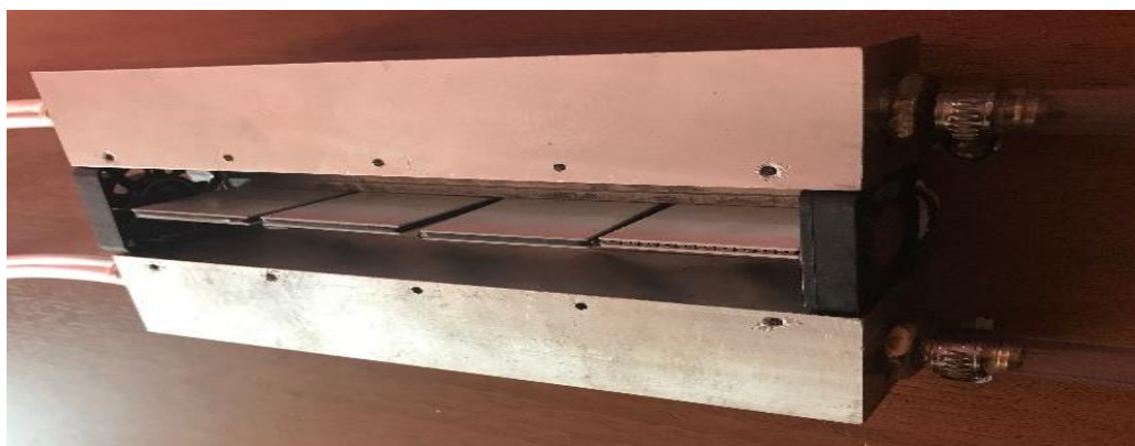
Рис.2. Внешний вид термоэлектрического интенсификатора теплопередачи Fig.2. Appearance of the thermoelectric heat transfer intensifier
