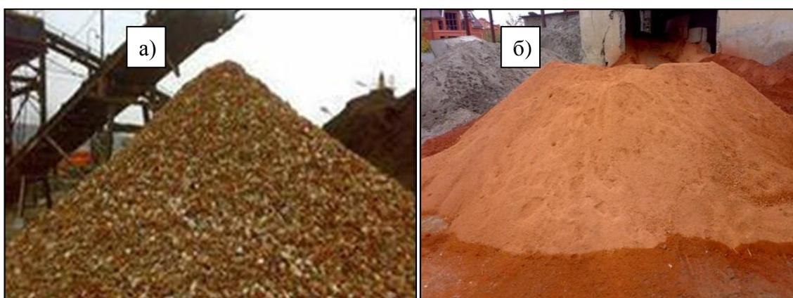
**Рисунок 3** - Дробление кирпичного боя для вторичного использования его в бетоне: а – щебень из ККБ; б – песок из ККБ
