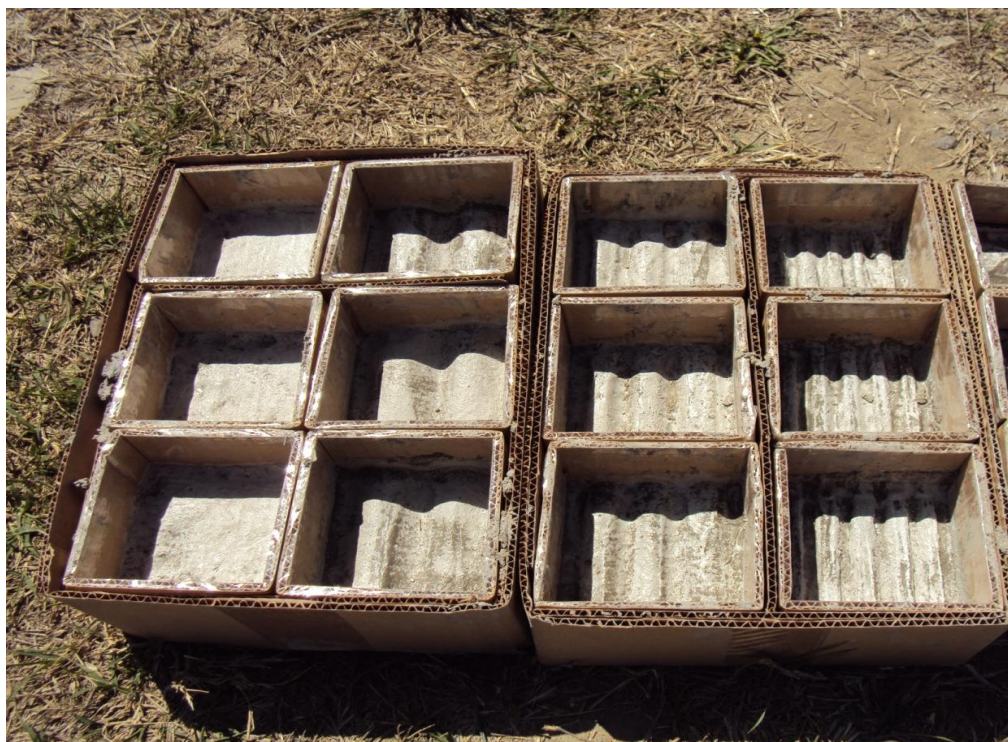
Рисунок 1 - Общий вид образцов с синусоидальными и плоскими стыками после заливки первого слоя
