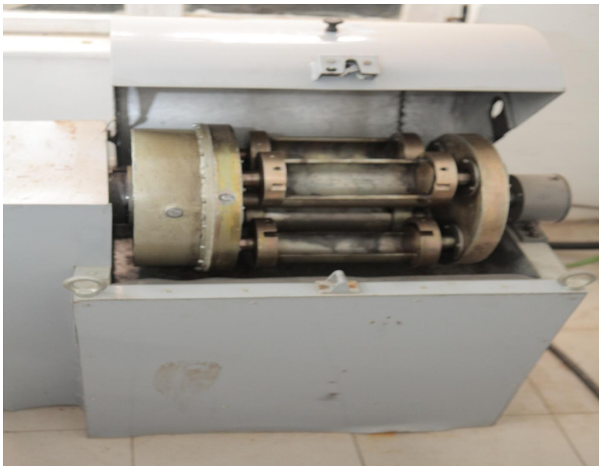
Рисунок 1 - Активатор 4М (планетарная мельница) для активации вяжущих компонентов до механохимических реакций
